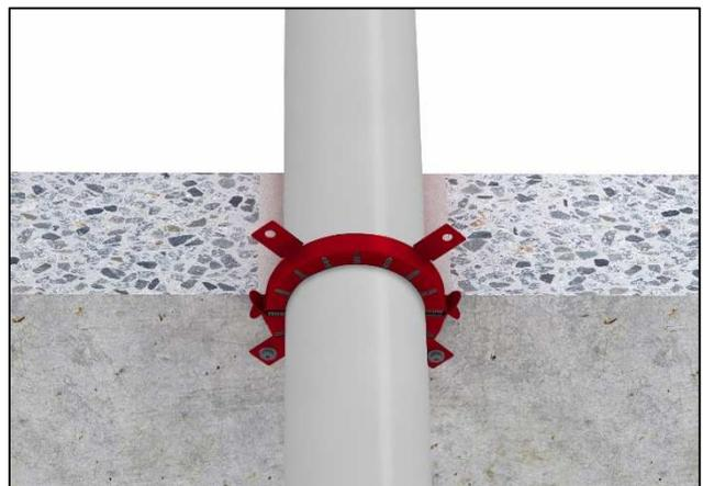
Figura 2—applicazione a solaio per tubazione combustibile
